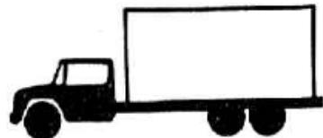
A.3 Appartient à cette catégorie tout véhicule routier d'une seule unité muni d'un ensemble de 2 essieux de catégorie B.2 ou B.3 et d'un essieu tandem à l'arrière dont la distance entre le centre de l'essieu arrière de l'essieu tandem avant ou de l'essieu multiple avant et le centre de l'essieu avant de l'essieu tandem à l'arrière est de 3 m ou plus, tel que ci-après imposé:
